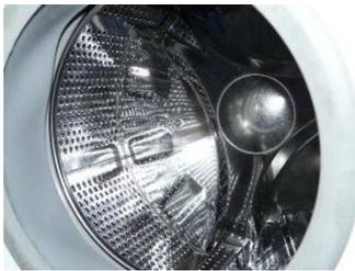
La fotografía muestra el interior del tambor de una lavadora, que es un cilindro perforado con un eje central y una pala para mover la ropa.
