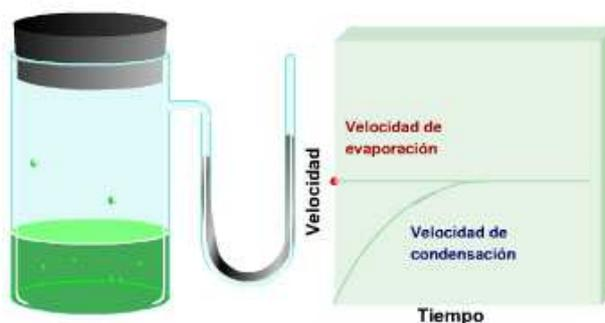
Llega un momento en que el manómetro no acusa variación de presión si la temperatura no varía, con lo que las propiedades macroscópicas del sistema vapor y del sistema líquido permanecen inalteradas: se dice entonces que se ha alcanzado un estado de equilibrio. La presión que ejerce el vapor se conoce como **presión de vapor del líquido** y es función de la naturaleza del líquido y de la temperatura.
